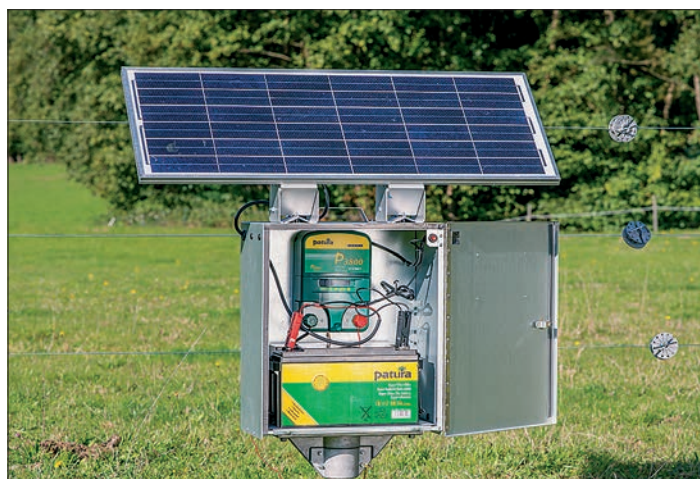
Für entlegene Weiden gibt es Akku-Weidezaungeräte mit Solarmodulen.
