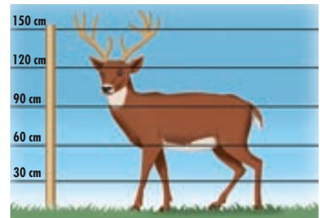
La clôture mesure jusqu'à 1,50 m de hauteur et comporte 5 fils.
