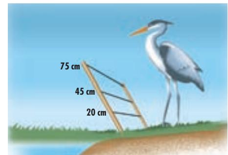
La clôture mesure environ 0,75 m de hauteur et comporte 2 à 3 fils. Si la berge est meuble, il faudra incliner la clôture en direction du plan d'eau.
