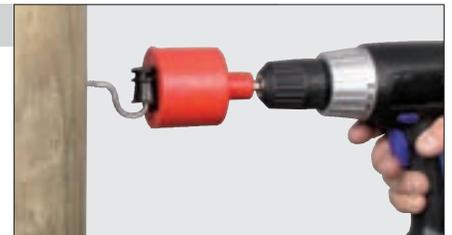
La partie jaune enlevée, l'isoflott permet le vissage des isolateurs à rainure
