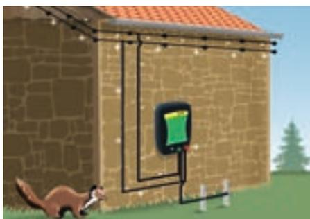
La clôture possède au moins 2 fils rapprochés, reliés en alternance au pôle + et au pôle - de l'électrificateur.
