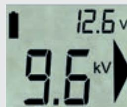
Position commutateur 2 : test batterie
