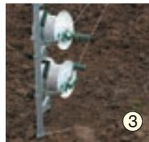
Prendre les bouts des fils électro-plastiques sur les enrouleurs et les débobiner
