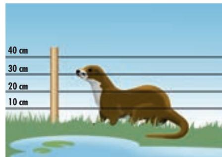
La clôture mesure environ 0,40 m de hauteur et comporte 4 fils.
