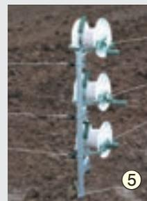
⑤ Fixer les fils électro-plastiques en bout de ligne de clôture et...
