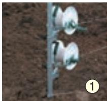
Placer le piquet de montage équipé des enrouleurs dans un angle
