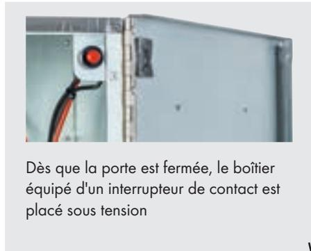
Dès que la porte est fermée, le boîtier équipé d'un interrupteur de contact est placé sous tension
