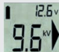
Position commutateur 2 : test batterie
