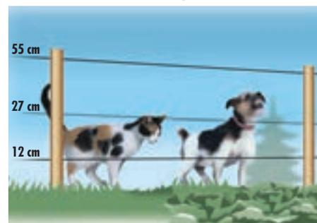
La clôture mesure entre 0,55 m et 0,75 m de hauteur et comporte 3 à 4 fils.
