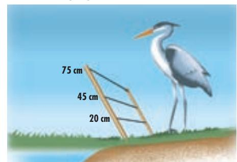
Elektrozäune zum Schutz gegen Fischreiher sind ca. 0,75 m hoch, mit 2 bis 3 Drähten. Bei seichtem Uferverlauf ist der Zaun zur Wasserfläche hin geneigt.
