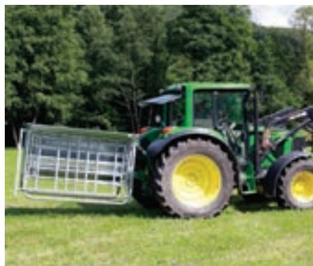
Transport über Dreipunkthängung mit beigeklapptem Kälberschlupf
