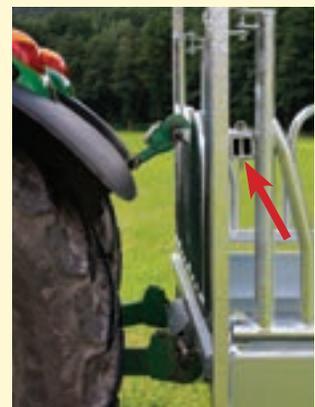
Stabile Konstruktion für leichtes Anhängen über Ackerschienen und massive Oberlenkeranhangung (abnehmbar) aus 8 mm Vierkantrohr
