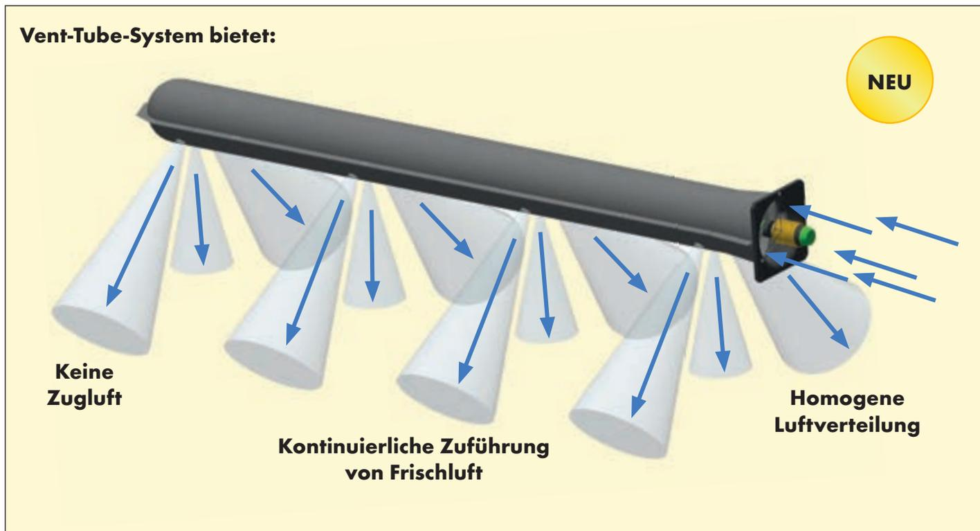
VentTubes bringen sehr viel frische, zugfreie und gleichmäßig verteilte Luft in Tiernähe, um Feuchtigkeit, Gase, Pathogene aus der Luft und/oder übermäßige Hitze zu entfernen. Ihre Kälber wachsen in einer optimalen Umgebung auf und bleiben dadurch gesund.
