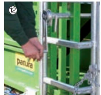
12 Rückschlagfreie Hinterfußwinde zum leichten Anheben der Hinterfüße
