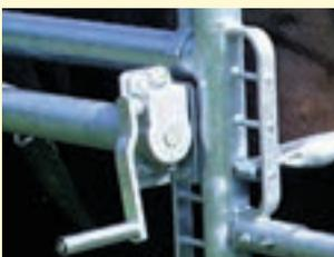
Komfortable selbsthemmende Schneckenwinde zum Anheben bzw. Ablassen der Bauchgurte
