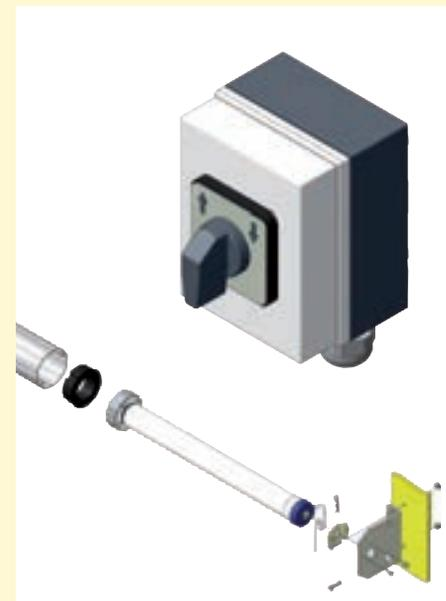
Elektro-Antrieb mit 230 Volt Rohr-Motor (16 s/m) und Drehschalter mit Selbst-Haltefunktion
