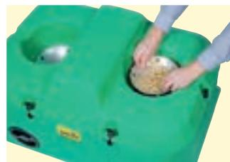
Thermolac 40B/75B: Schnelle werkzeuglose Entnahme der Tränkeschale
