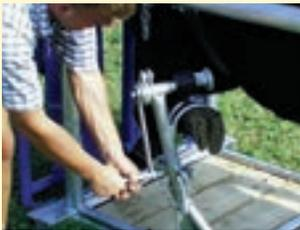
Komfortable Vorderfußwinde zum leichten Anheben der Vorderfüße
