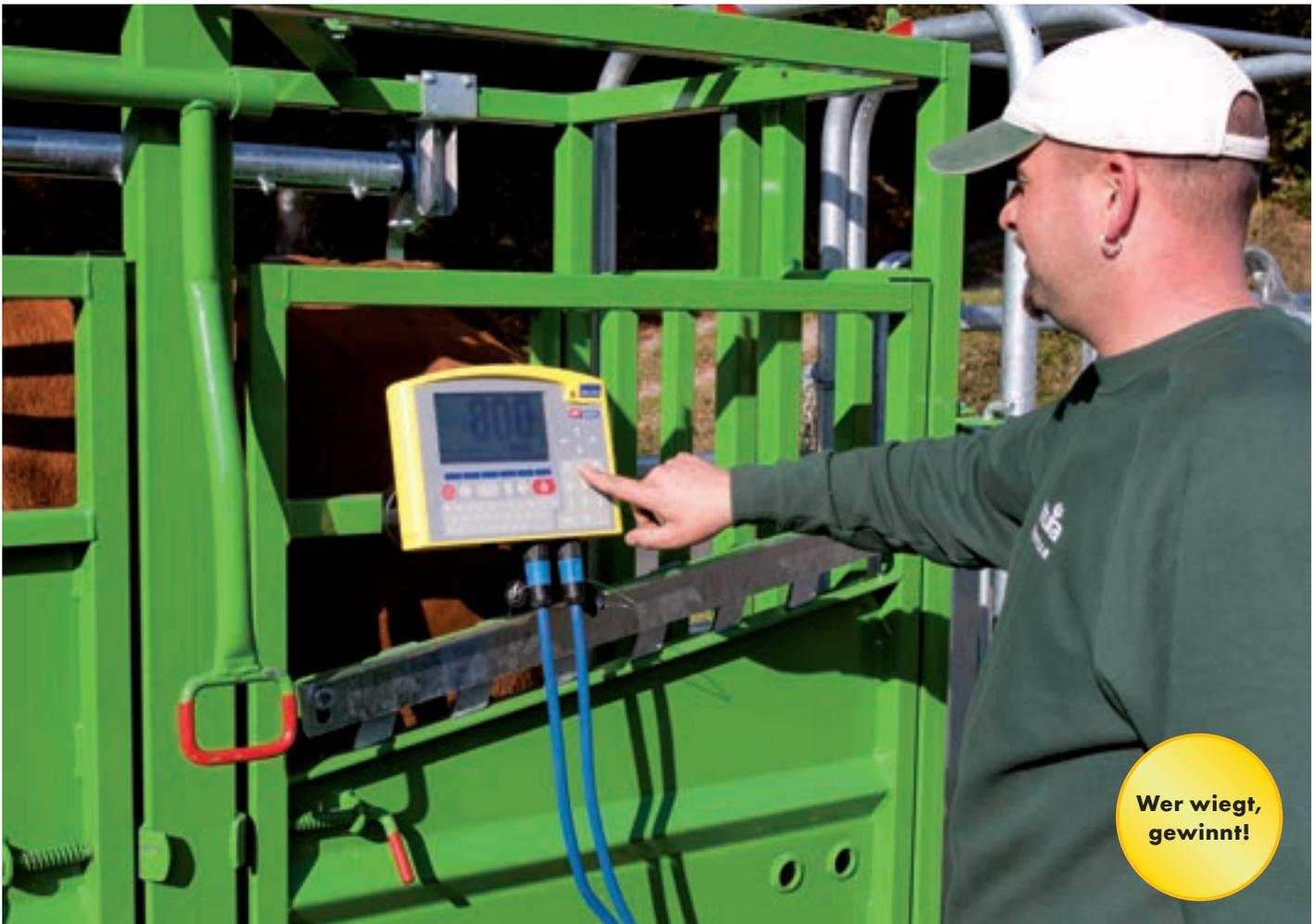
Der PATURA Behandlungsstand mit elektronischer Tru-Test Waage, bestehend aus Wiegecomputer mit Digitalanzeige und 2 Wiegebalken (siehe Kapitel Wiegetechnik)
