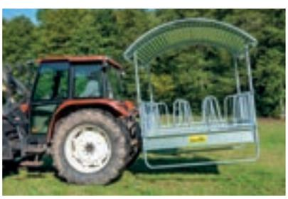
Transport über Dreipunkthanhängung, ungefüllt mit max. 10 km/h
