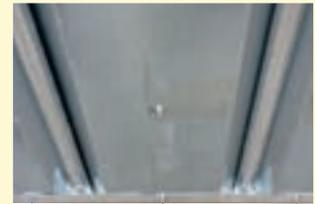
Doppelte Verstärkungsrohre unter dem Bodenblech
