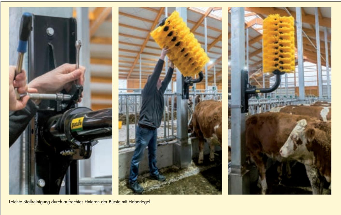
Leichte Stallreinigung durch aufrechtes Fixieren der Bürste mit Heberiegel.
