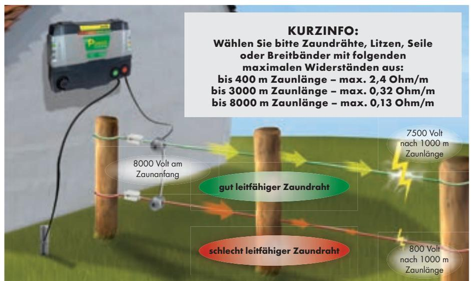
Nur hochleitfähige Zaundrähte sorgen bei größeren Zaunlängen für maximale Leistung bis zum Zaunende.
