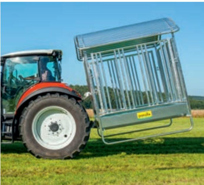
Transport über Dreipunkthängung, ungefüllt mit max. 10 km/h
