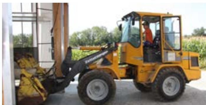
Zur rationellen Entmistung mit dem Hoflader lassen sich alle Boxenzwischenwände komplett wegklappen - jede Boxenreihe ist auf der kompletten Länge befahrbar
