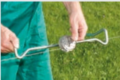
3. Spannbügel in den Draht einhängen, Sicherungsbügel einsetzen und Spannbügel entnehmen
