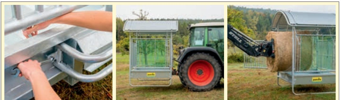
Optional: Dreipunktschutzbügel zum Abdecken der Dreipunktanhängung
