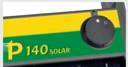
Die Aktivierung des Gerätes erfolgt mittels eines magnetischen Drehschalters. Die integrierte Elektronik regelt dann die abgegebene Impulsenergie automatisch in Abhängigkeit vom Ladezustand des Akkus. Somit ist ein wartungsfreier Betrieb vom Frühjahr bis zum Herbst problemlos möglich.
