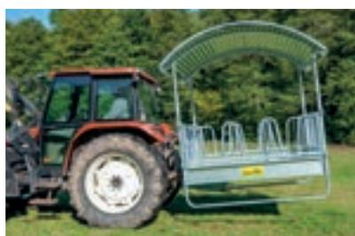
Transport über Dreipunktanhängung, ungefüllt mit max. 10 km/h
