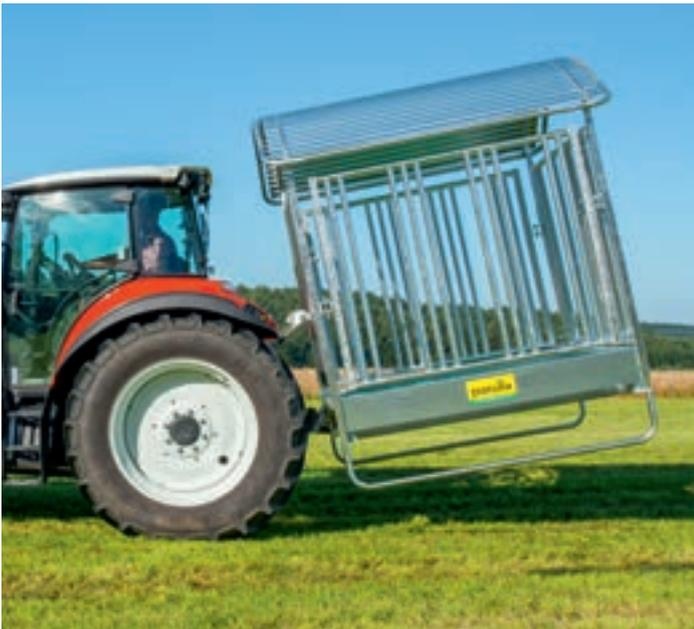
Transport über Schlepperdreipunkt, ungefüllt mit max. 10 km/h
