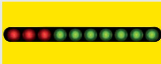
Auf Schalterstellung 3 bis 6 wird in Schritten von 1000 V die Zaunspannung angezeigt; Auf Schalterstellung 2 wird der Ladezustand der Batterie in Schritten von 10 % angezeigt
