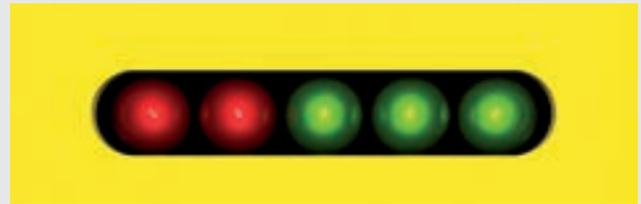
Auf Schalterstellung 3 bis 6 wird die Zaunspannung angezeigt; auf Schalterstellung 2 wird der Batteriezustand angezeigt
