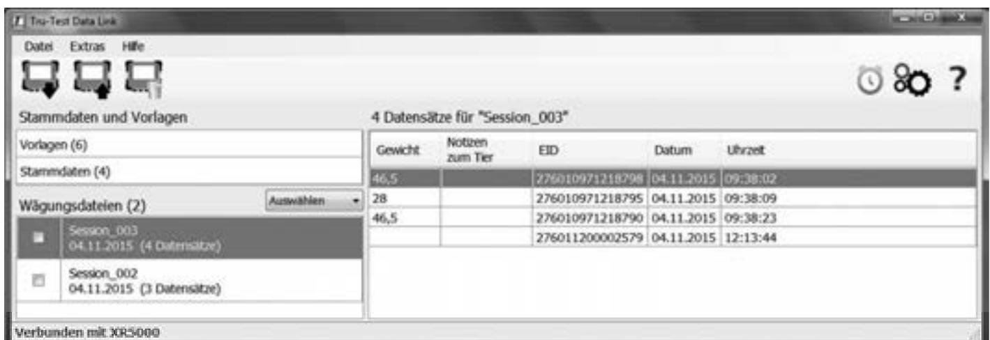
Die Anzeigeeinheiten der Serie 5000 und das EziWeigh Modell 7 beinhalten eine Übertragungssoftware, um alle Daten auf den PC zu übertragen bzw. auch wieder zurück. Ein direktes Öffnen und Bearbeiten der Dateien in einer Tabellenkalkulationssoftware ist möglich. Zusätzlich können Sie ausführliche Berichte direkt in den Anzeigeeinheiten erstellen.
