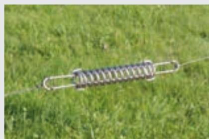
4. Die Befestigung auf der anderen Seite wiederholen und Feder mit dem rotierenden Spanner vorspannen
