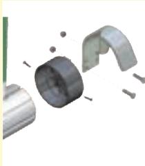
J-Halteklammer zur Sicherung des unteren Profilrohres
