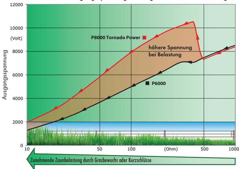
Die Ausgangsspannung des neuen P8000 Tornado Power ist im Hauptarbeitsbereich unter 500 Ohm deutlich höher als die des gleich starken P6000.
