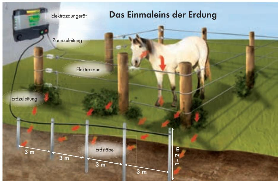
So sieht die typische Erdungsanlage für Netzgeräte aus. Achten Sie auf perfekte Erdung, denn über 80 % der installierten Erdungssysteme sind unzureichend. Bitte beachten Sie die Empfehlungen zur Anzahl der Erdstäbe in den Tabellen bei den jeweiligen Elektrozaungeräten.
