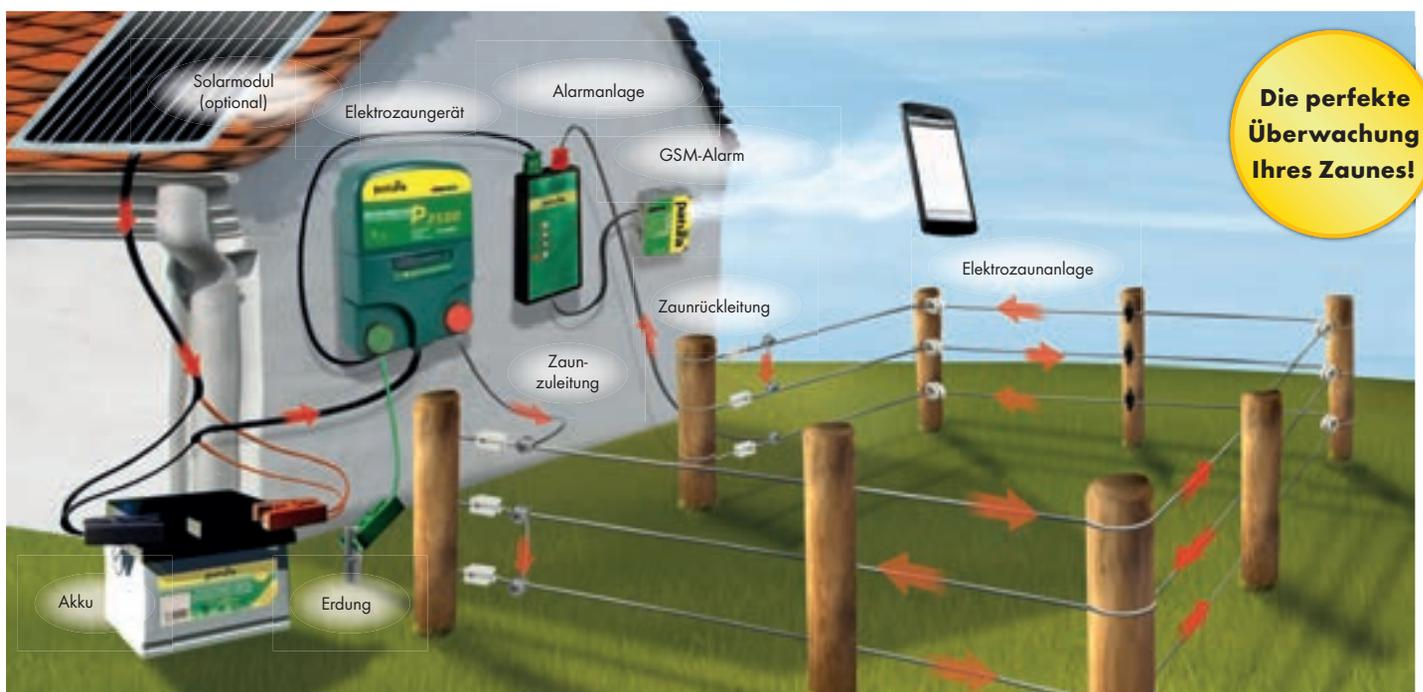
Schematischer Aufbau einer per GSM-Alarm überwachten Elektrozaunanlage für Batteriebetrieb (mit Option Solaranschluss) – Innerhalb weniger Minuten wird der Weidezäunalarm von der entferntesten Koppel aufs Handy bzw. Telefon übertragen.
