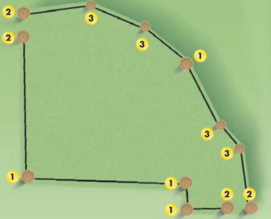
Draufsicht auf eine Festzaun-Koppelanlage mit Angaben zur Verwendung von Eckpfosten.
