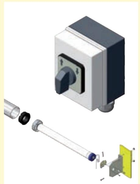
Elektro-Antrieb mit 230 Volt Rohr-Motor (16 s/m) und Drehschalter mit Selbst-Haltefunktion
