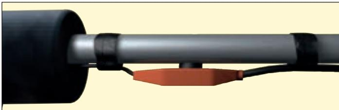
Thermostat mit Fühlerkontakt fest an die Rohrleitung anlegen und mit Isolierband umwickeln; die Platzierung des Thermostates sollte unbedingt an der kältesten Stelle der Wasserleitung erfolgen.
