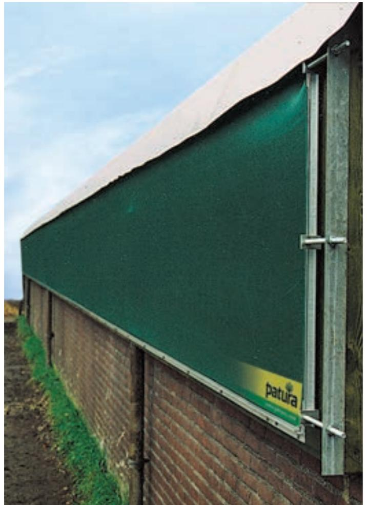
Fest installierte Windschutznetze mit Alu-Profilen und Spannvorrichtung
