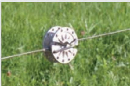
4. Durch das geringe Gewicht hangt der Spanner leicht im Zaundraht
