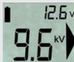
Schalterstellung 2 (Batterietest)
