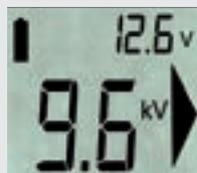
Schalterstellung 2 (Batterietest)
