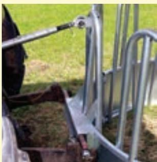
Dreipunkthängung für Transport an der Ackerschiene
