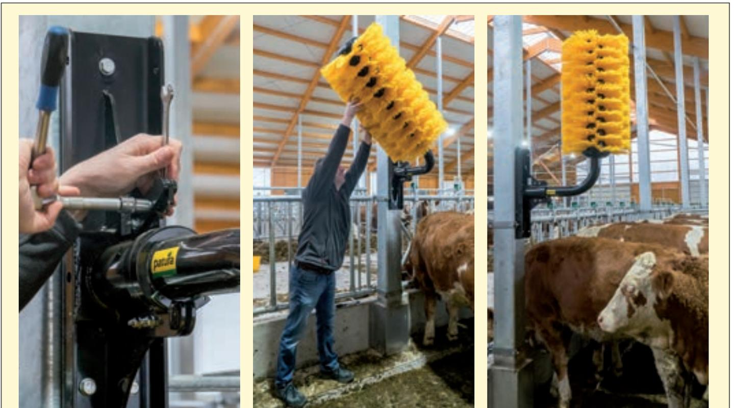
Leichte Stallreinigung durch aufrechtes Fixieren der Bürste mit Heberiegel.
