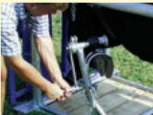
Komfortable Vorderfußwinde zum leichten Anheben der Vorderfüße
