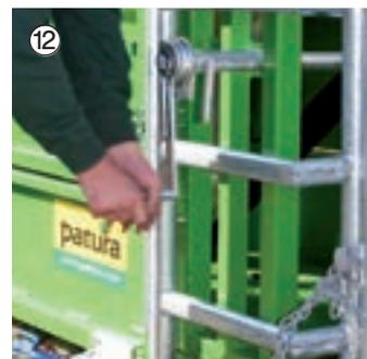
12 Rückschlagfreie Hinterfußwinde zum leichten Anheben der Hinterfüße
