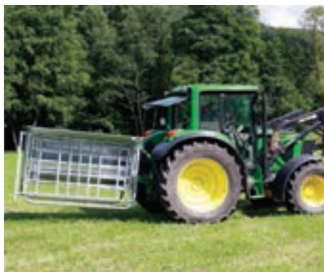
Transport über Schlepper-Dreipunkt-Anhängung mit beigegeklapptem Kälberschlupf
