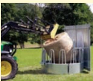
Abklappbares Dach für leichte Beschickung von oben
