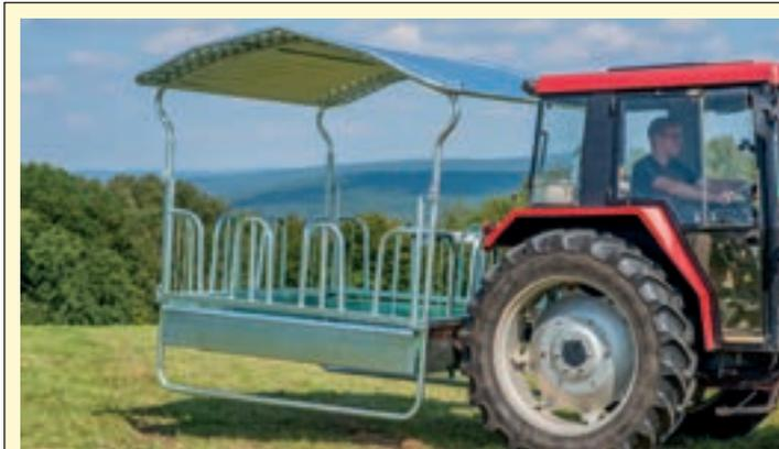
Transport über Schlepperdreipunkt, ungefüllt mit max. 10 km/h
