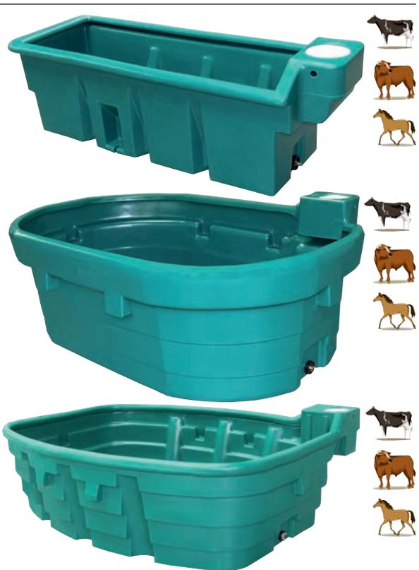
Die Weidetröge sind aus hochwertigem, UV-beständigem Polyethylen. Der Rand ist nach innen gebogen, dadurch keine Wasservergeudung. Eine große Ablauföffnung sorgt für eine schnelle, einfache Entleerung und Reinigung. Die Weidetröge gibt es von 70 l bis 1500 l mit den jeweilig passenden Schwimmerventilen (Hoch- und Niederdruck).
