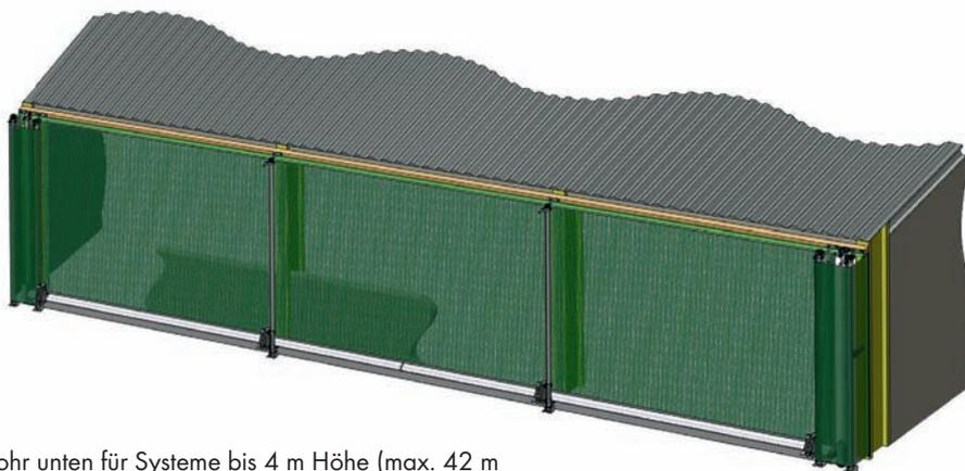
Wickelrohr unten für Systeme bis 4 m Höhe (max. 42 m Länge) und bis 70 m Länge (max. 1 m Höhe)
