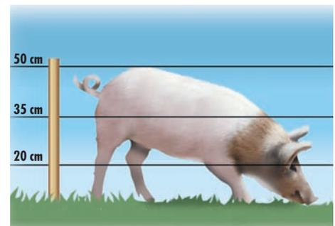
Elektrozäune für Schweine sind 0,50 m bis 0,75 m hoch, mit 2 bis 3 Drähten. Außenzäune für Hausschweine sind mit einem zweiten wilddichten Zaun zu versehen!
