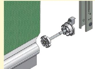
Langlebige Nylonführung und eine robuste U-Profilschiene (optional) garantieren eine hohe Stabilität
