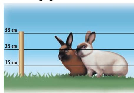
Elektrozäune zum Schutz gegen Hasen und Kaninchen sind ca. 0,55 m hoch, mit 3 Drähten. Um bei Kaninchen ein Untergraben des Zaunes zu verhindern, ist eventuell ein geerdeter Draht unter dem Zaun direkt auf dem Boden zu verlegen. Der Zaun sollte leicht zur Tierseite hin geneigt werden.
