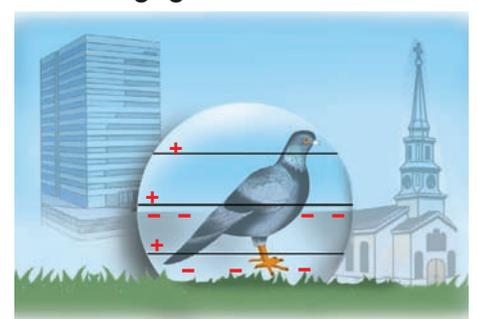
Elektrozäune zur Abwehr von Tauben an Gebäudefassaden bestehen aus 1 bis 3 Drähten, die über einer leitfähigen, geerdeten Grundfläche verlaufen.
