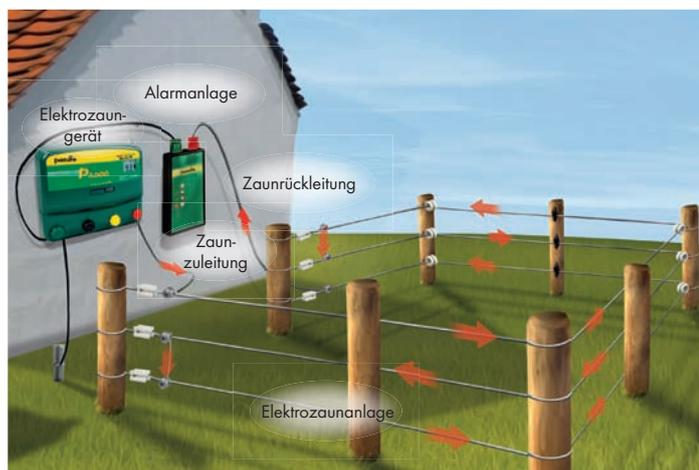
Höchste Sicherheit für alle Elektrozaungeräte durch die lückenlose Überwachung des Zaunes nach dem Zaunschleifensystem mit der Alarmanlage.
