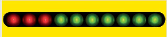
Auf Schalterstellung 3 bis 6 wird die Zaunspannung angezeigt; auf Schalterstellung 2 wird der Batteriezustand angezeigt
