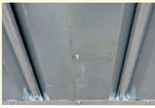
Doppelte Verstärkungsrohre unter dem Bodenblech
