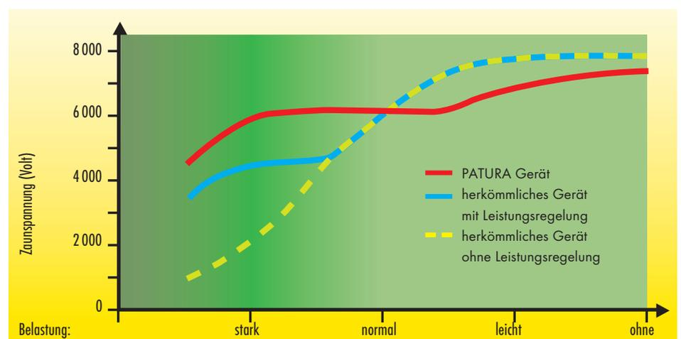
Spannungsverlauf eines PATURA Gerätes im Vergleich zu herkömmlichen Geräten. Gerade bei Bewuchs am Zaun haben PATURA Geräte eine deutlich höhere Spannung.
