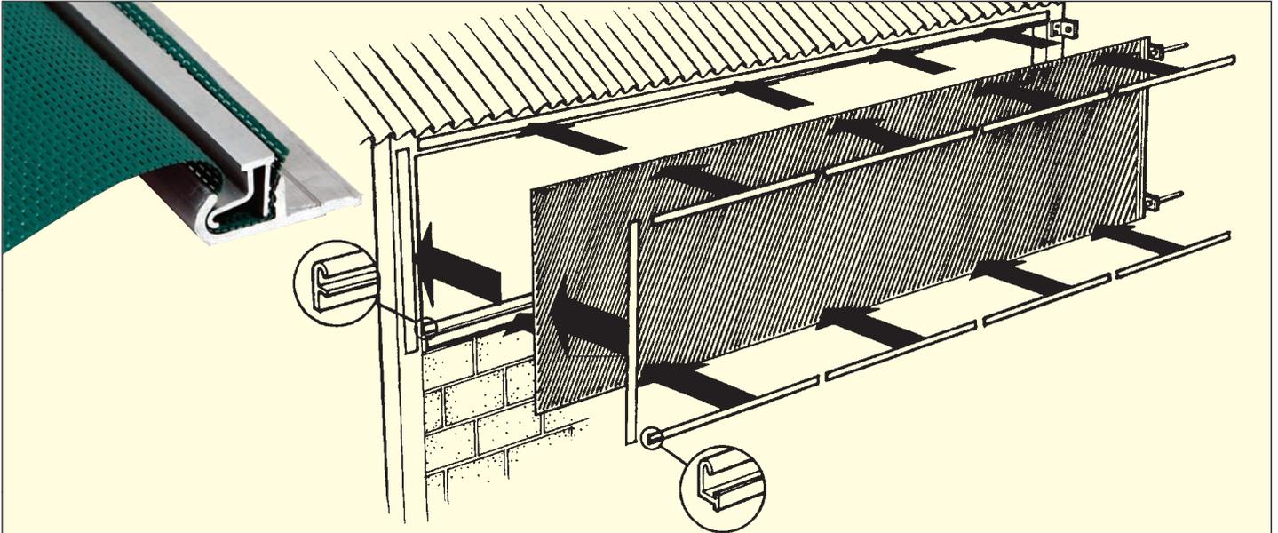
Fest installierte Windschutznetze sind über spezielle Aluminiumprofile leicht am Gebäude zu befestigen: Alu-Grundprofile alle 50 cm am Gebäude festschrauben - Netz einlegen und spannen - Klemmprofil eindrücken
