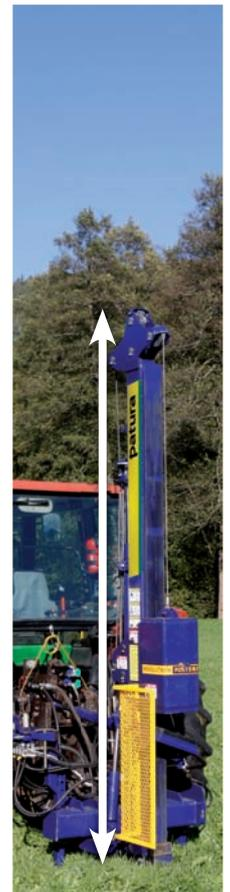
Bei "Profi 1" und "Profi 2" kann der Mast von 3,30 m auf 5,10 m ausgezogen werden. Das erlaubt kompakten Transport und Pfostenlängen bis zu 4,20 m.
