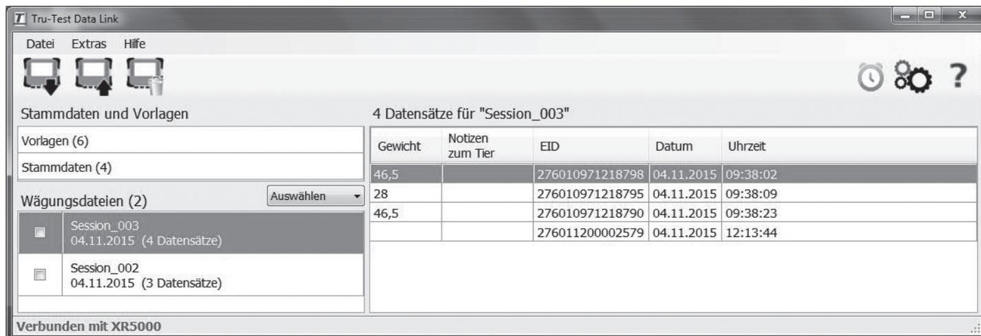
Die Anzeigeeinheiten der Serie 3000, 5000 und die EziWeigh Modelle 6 und 7 beinhalten eine Übertragungssoftware, um alle Daten auf den PC zu übertragen bzw. auch wieder zurück. Ein direktes Öffnen und Bearbeiten der Dateien in Tabellenkalkulationssoftware ist möglich. Zusätzlich können Sie ausführliche Berichte direkt in den Anzeigeeinheiten erstellen.
