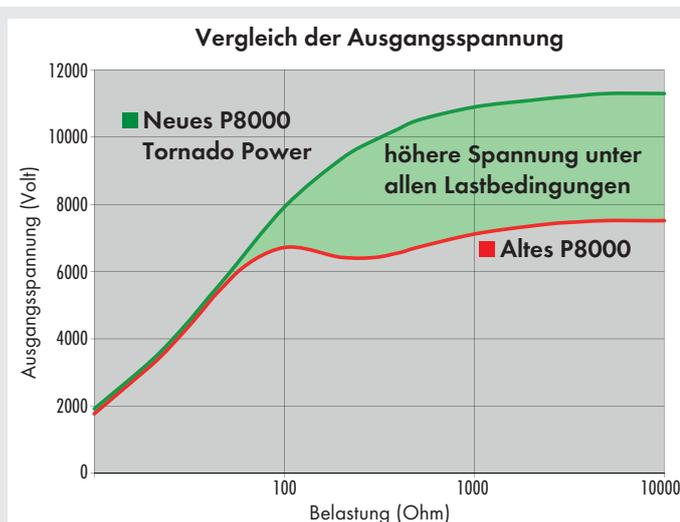
Im gesamten Arbeitsbereich ist die Ausgangsspannung des neuen P8000 Tornado Power höher als die des alten P8000
