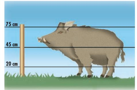
Elektrozäune zum Schutz gegen Schwarzwild sind 0,55 m bis 0,75 m hoch, mit 2 bis 3 Drähten.
