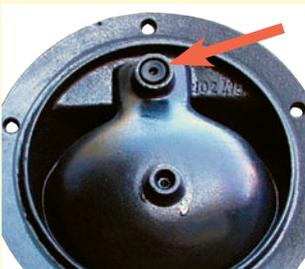
Boden des Modells 41A mit automatisch dichtendem Kugelflansch
