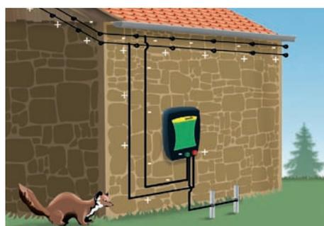
Elektrozäune zur Abwehr von Mardern und Waschbären bestehen aus mindestens 2 Drähten in geringem Abstand, welche im Wechsel mit dem + und - Pol des Gerätes verbunden sind.
