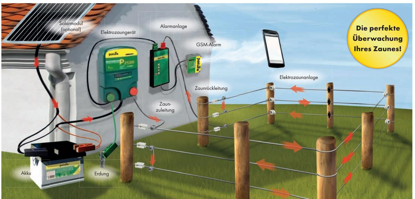
Schematischer Aufbau einer per GSM-Alarm überwachten Elektrozaunanlage für Batteriebetrieb (mit Option Solaranschluss) – Innerhalb weniger Minuten wird der Weidezaunalarm von der entferntesten Koppel aufs Handy bzw. Telefon übertragen.
