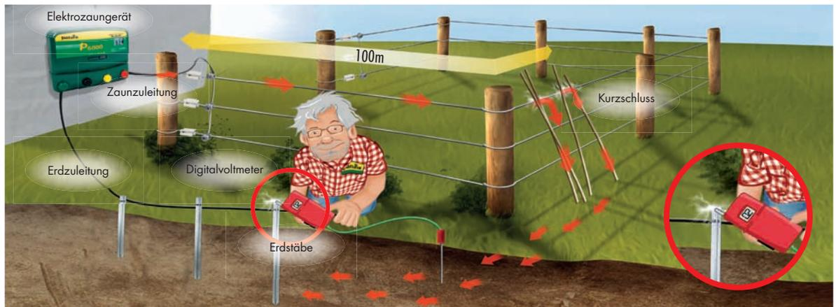
Regelmäßige Erdungskontrolle speziell bei trockenen Bodenverhältnissen sorgt für hohe Sicherheit am Zaun.
