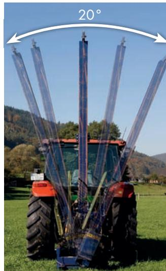
Durch die Seitenneigung nach links und rechts bis 20° können auch in unebenem Gelände mit bis zu 45 % Gefälle Pfosten noch senkrecht eingrammt werden.
