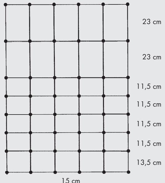
TornadoXL-Elektrozaunnetz 1,05 m für Schafe und Lämmer: 14 Pfähle mit Doppelspitze, 8 horizontale Kunststofflitzen, davon die oberen 7 stromführend (oberste Litze 6 x 0,20 mm Edelstahlleiter + 3 x 0,25 mm Kupferleiter, darunter 6 Litzen mit je 3 x 0,20 mm Edelstahlleiter)
