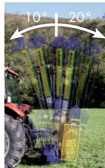
Steht der Schlepper bergauf ist senkrecht Rammen bis 22 % Gefälle möglich, steht er bergab sind bis zu 45 % möglich.
