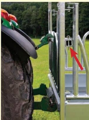
Stabile Konstruktion für leichtes Anhängen über Ackerschleife und massive Oberlenkeranhangung (abnehmbar) aus 8 mm Vierkantröhre
