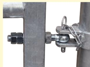
Verstellbare Aufhängung unten mit Augenschraube M22 zum Ausgleich von schrägen Montagepfosten
