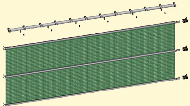
Windschutz-Spannpaneele können mit einer Laufschiene kombiniert auch als leichte Vorhangausführung eingesetzt werden
