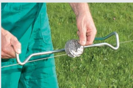
3. Spannbügel in den Draht einhängen, Sicherheitsbügel einsetzen und Spannbügel entnehmen
