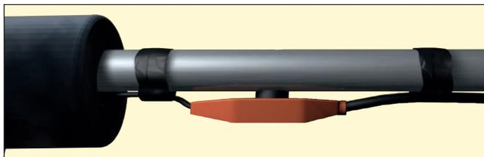
Thermostat mit Fühlerkontakt fest an die Rohrleitung anlegen und mit Isolierband umwickeln; die Platzierung des Thermostates sollte unbedingt an der kältesten Stelle der Wasserleitung erfolgen.
