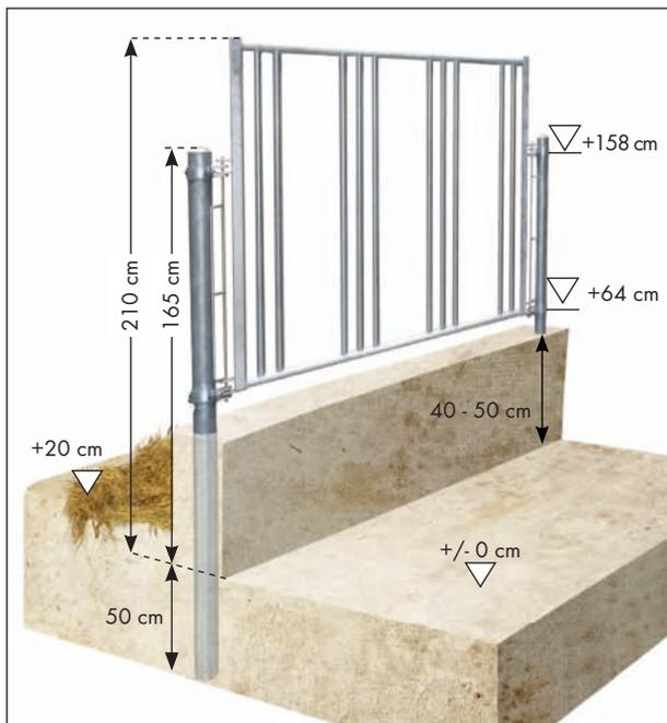
Funktionsmaße Sicherheits-Fressgittermontage für Pferde unter Verwendung der Montagepfosten
