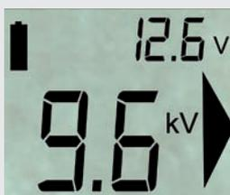
Schalterstellung 2 (Batterietest)
