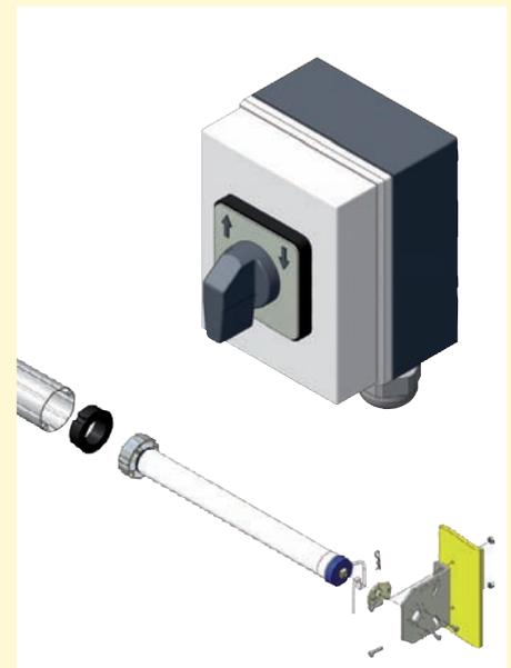
Elektro-Antrieb mit 230 Volt Rohr-Motor (16 s/m) und Drehschalter mit Selbst-Haltesfunktion
