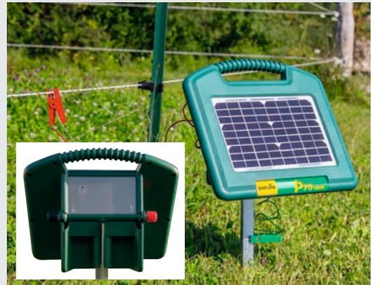
Platzieren Sie das Gerät mit dem Montageschlitz direkt auf einem Erdstab (oder T-Pfosten). Das Gerät sollte nicht auf dem Boden stehen. Das Solarmodul muss exakt nach Süden ausgerichtet sein.
