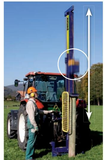
Der PATURA "Farmer" im Einsatz: Pfosten bis 3 m Länge können eingrammt werden.
