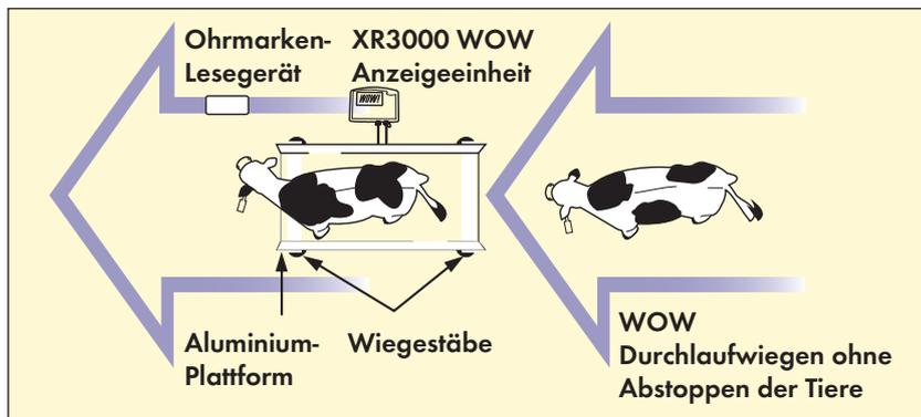
Durchlaufwiegen wird das Wiegen revolutionieren. Wiegen wird, ohne jeden Zeitaufwand und ohne das Tier abzustoppen, möglich. Das Tier wird elektronisch identifiziert, das Gewicht beim Laufen über die Plattform automatisch aufgezeichnet. Die Identifizierung erfolgt über ein Ohrmarkenlesegerät, welches die Information an die Anzeigeeinheit XR3000 WOW weitergibt. **Durchlaufwiegen setzt voraus, dass die Tiere regelmäßig und ruhig die Plattform passieren, wie z.B. bei Milchkühen nach dem Melken.**
