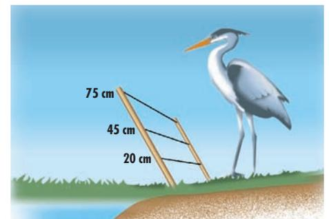
Elektrozäune zum Schutz gegen Fischreiher sind ca. 0,75 m hoch, mit 2 bis 3 Drähten. Bei seichtem Uferverlauf ist der Zaun zur Wasseroberfläche hin geneigt.
