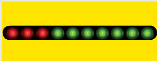
Auf Schalterstellung 3 bis 6 wird in Schritten von 1000 V die Zaunspannung angezeigt; Auf Schalterstellung 2 wird der Ladezustand der Batterie in Schritten von 10 % angezeigt
