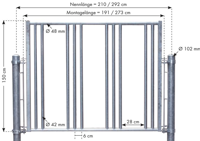
**Geschweißtes Fressgitter - für leichte Montage**
