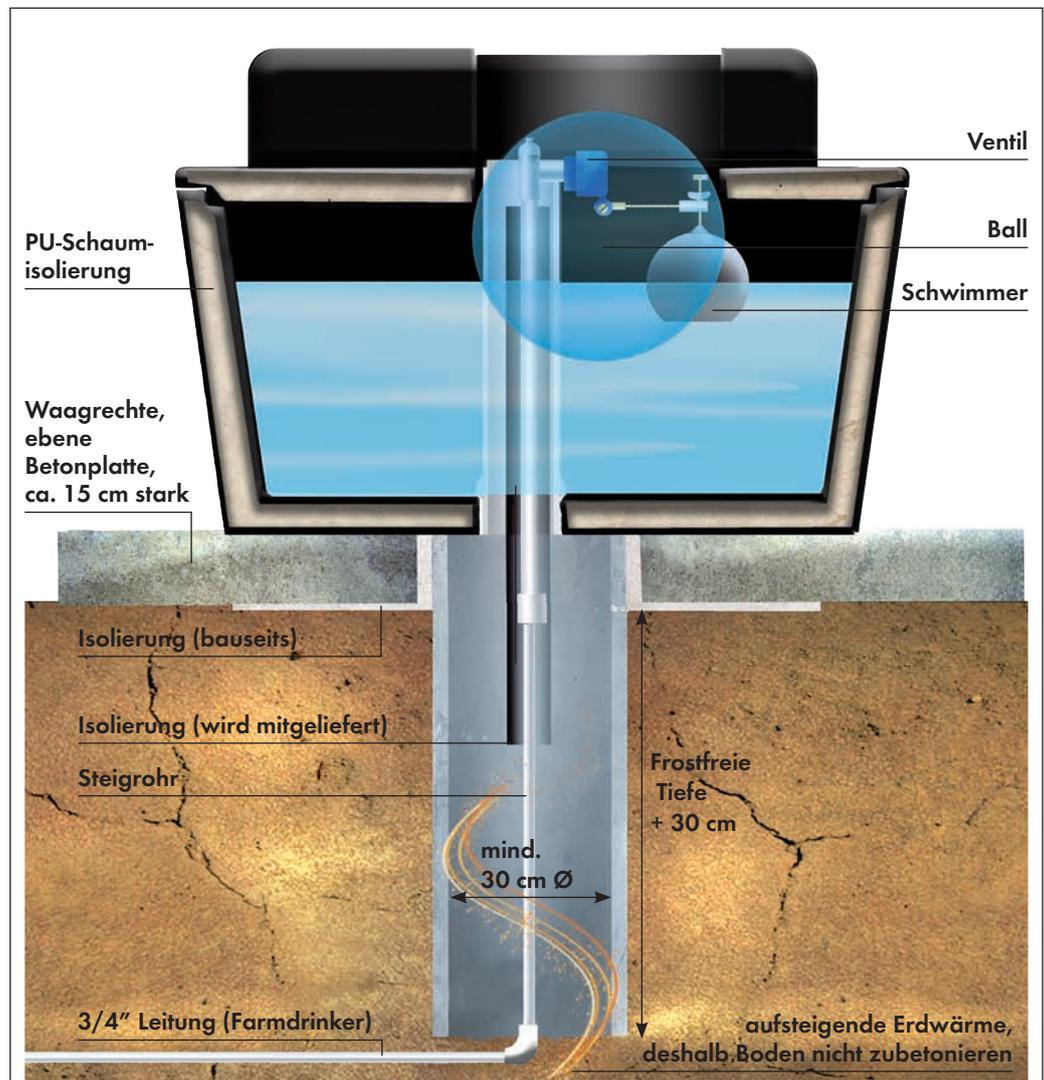
Seitenansicht Betonplatte, Steigrohr und Zuleitung für Farmdrinker
