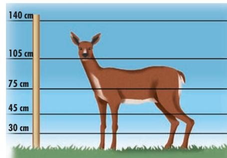
Elektrozäune zum Schutz gegen Rehwild sind bis zu 1,40 m hoch, mit 5 bis 6 Drähten.
