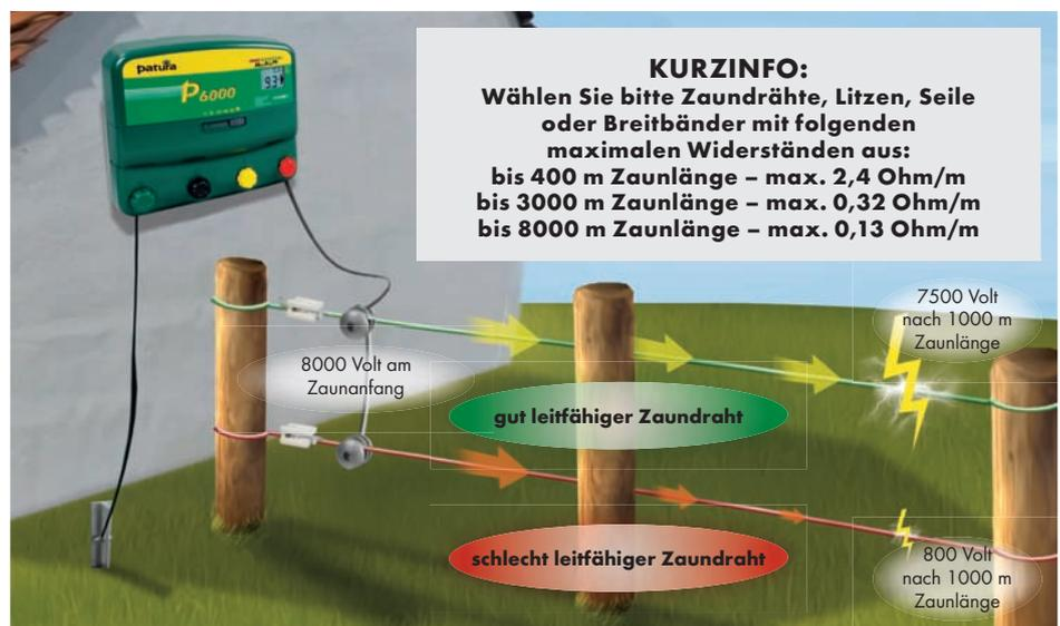
Nur hochleitfähige Zaundrähte sorgen bei größeren Zaunlängen für maximale Leistung bis zum Zaunende.
