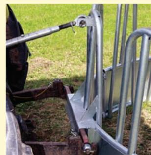
Dreipunktanhangung für Transport an der Ackerschiene
