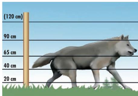
Elektrozäune zum Schutz gegen Wölfe sind bis zu 1,20 m hoch, mit 4 bis 5 Drähten.
