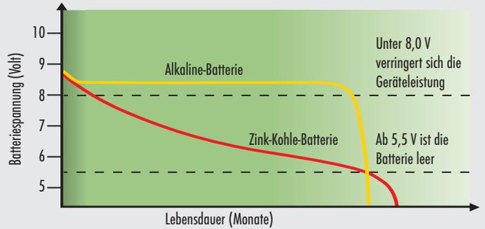
Der konstante Spannungsverlauf der PATURA Super-Alkaline-Batterien gibt Ihnen volle Geräteleistung bis zum letzten Tag.
