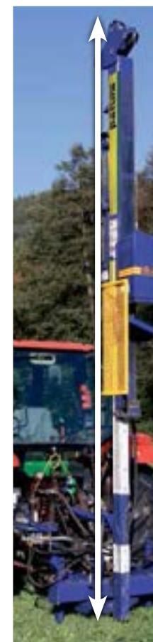
Bei "Profi 1" und "Profi 2" kann der Mast von 3,30 m auf 5,10 m ausgezogen werden. Das erlaubt kompakten Transport und Pfostenlängen bis zu 4,20 m.
