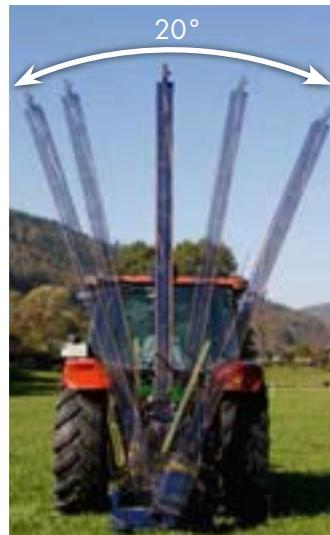
Durch die Seitenneigung nach links und rechts bis 20° können auch in unebenem Gelände mit bis zu 45 % Gefälle Pfosten noch senkrecht eingearbeitet werden.
