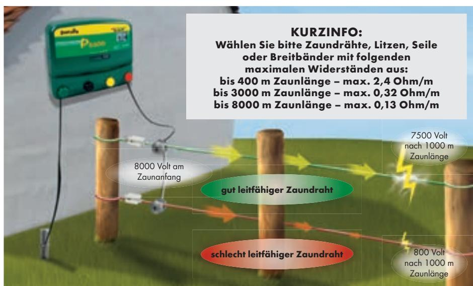
Nur hochleitfähige Zaundrahte sorgen bei größeren Zaunlängen für maximale Leistung bis zum Zaunende.
