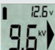
Schalterstellung 2 (Batterietest)
