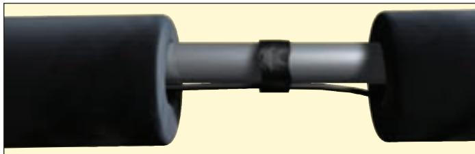
Heizkabel direkt unter der Wasserleitung verlegen und in regelmäßigen Abständen mit Isolierband befestigen; Wasserleitung zusätzlich mit Rohrisolierung von mindestens 13 mm isolieren.
